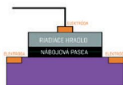
SCHEMA NAND FLASH TRANZISTORA S KLASICKÝM PLÁVAJÚCIM HRADLOM A JEHO DNES ČORAZ ČASTEJŠIE POUŽÍVANÝ VARIANT S NÁBOJOVOU PASCOU
