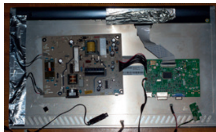
NAPÁJACIA A KONTROLNÁ ELEKTRONIKA V ÚTROBÁCH MONITORA
